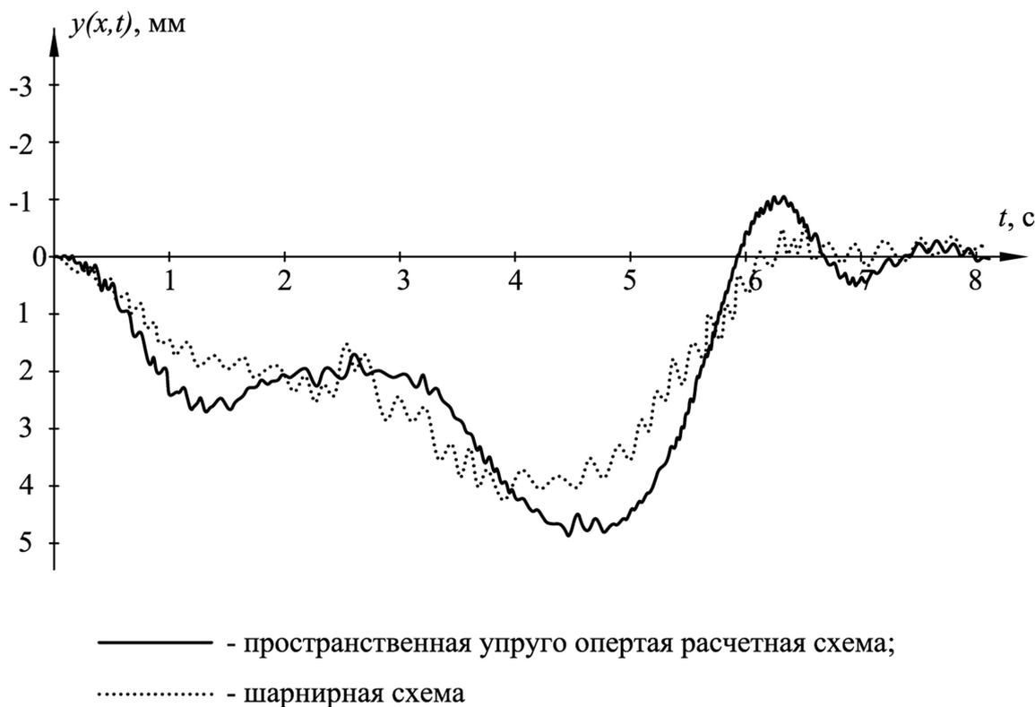
Рис. 5. Графики вертикальных прогибов среднего сечения при расчете по двум расчетным схемам
