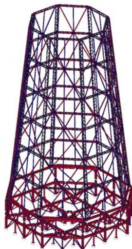
Рис. 2. Расчётная стержневая модель каркаса градирни
