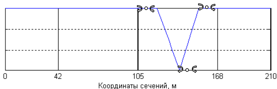
Рис. 4. Механизм разрушения мостового сооружения при передвижении по пролетному строению нагрузки Н14
