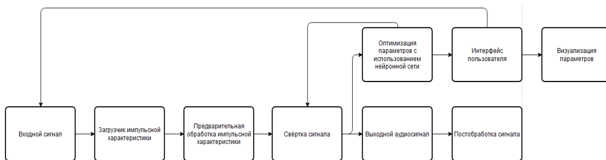
Рис. 1. Функциональные модули VST-плагина импульсного ревербератора
