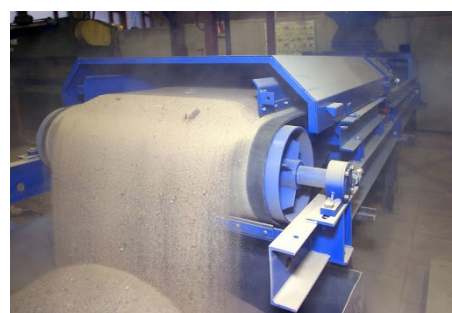
Рис. 1. Внешний вид дозатора автоматического ленточного весового непрерывного действия "КЛИМ-ВД" с аспирационным кожухом
