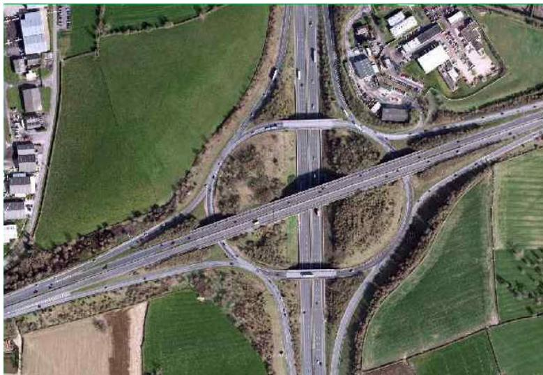
**Рис. 3.** Простейшее пересечение и примыкание дорог в разных уровнях
